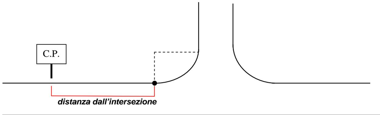
**Figura 7.b** *Distanza dalle intersezioni: intersezione con corsia di accumulo*
