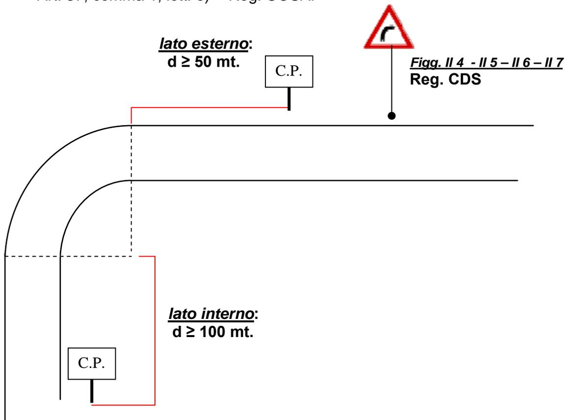
**Figura 8.c** *Divieto di installazione lungo le curve con raggio inferiore o uguale a 250 mt. e/o in presenza di segnaletica di pericolo - Art. 37, comma 2, lett. e) - Reg. COSAP*
