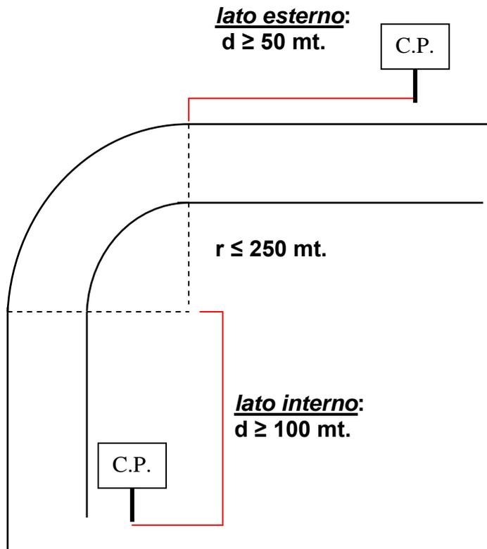
**Figura 8.b** Distanza dalle curve in presenza di segnaletica di pericolo -
