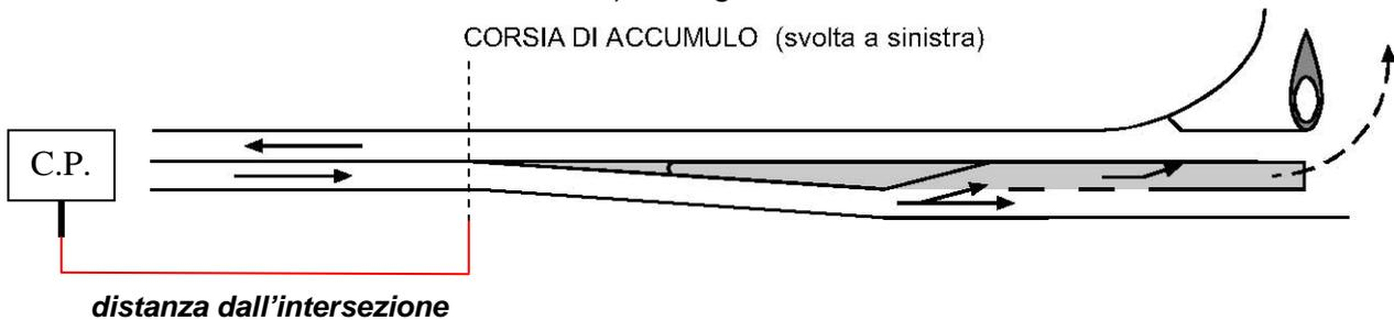
**Figura 7.c** *Distanza dalle intersezioni: intersezione con aiuola spartitraffico*
