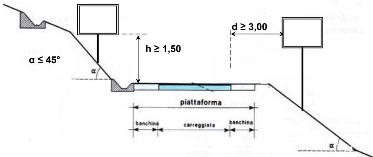
**Figura 10** - Distanze da rispettare per l'installazione di insegne pubblicitarie in ambito extraurbano con limite massimo di velocità superiore a 50 km/h (art. 51 Reg. CDS)
