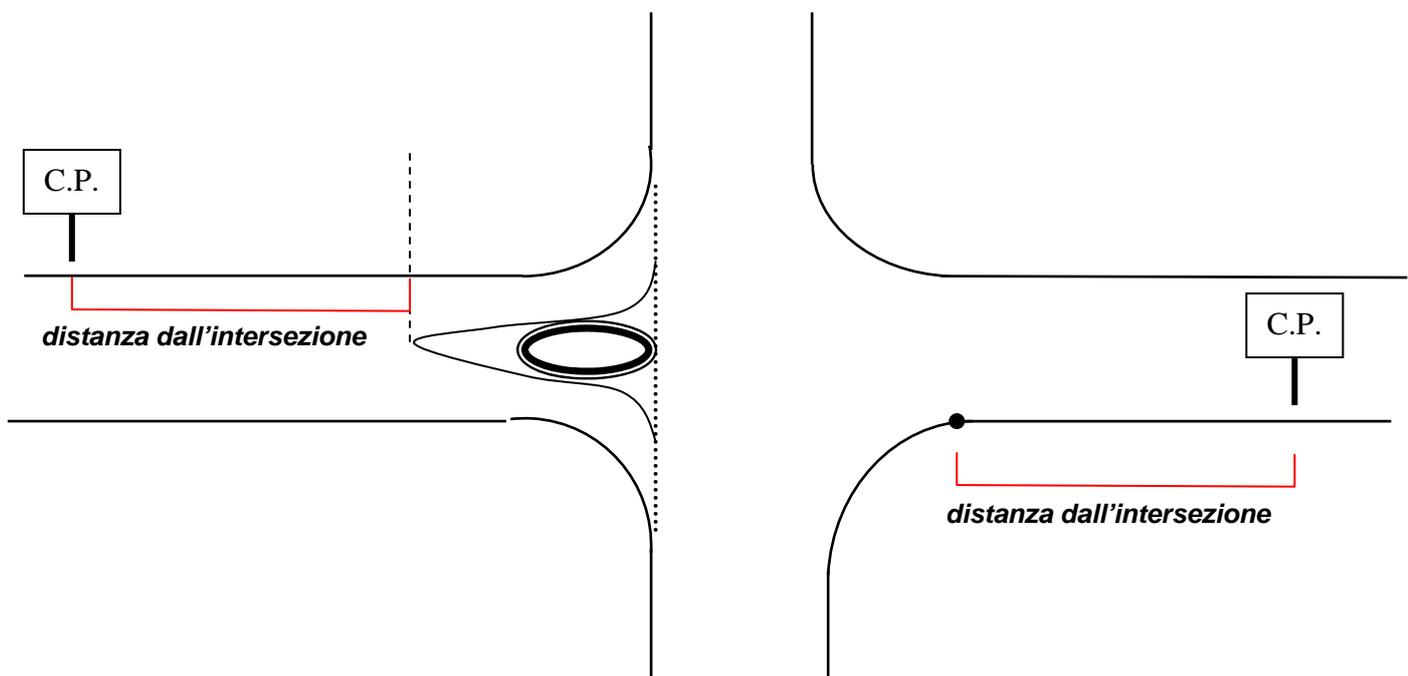
**Figura 8.a** Distanza dalle curve con raggio inferiore o uguale a 250 mt. -
